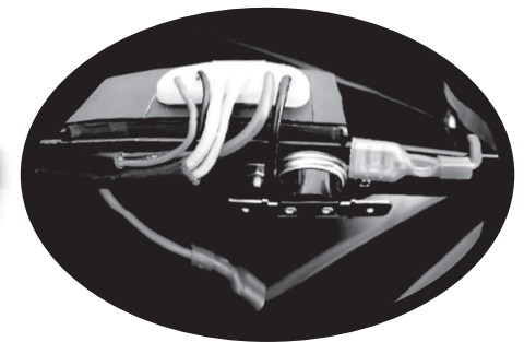
Disconnect the 2 thermostat connectors Desconecte los 2 conectores del termostato Débranchez les 2 connecteurs du thermostat
